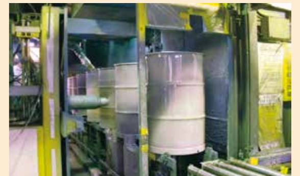
再生の塗装工程
